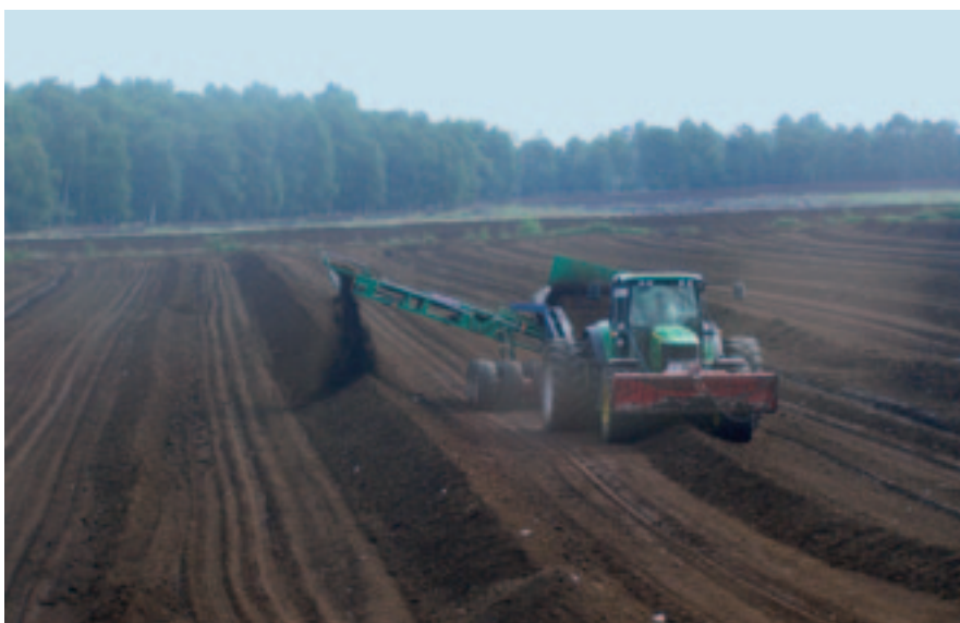
Těžba rašeliny frézováním – firma Gramoflor
